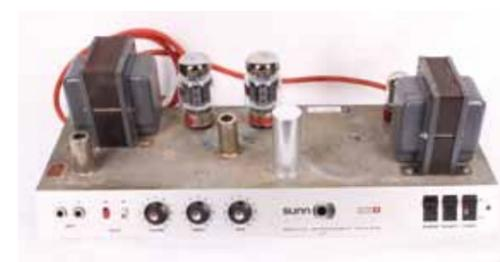
Mallory gegen hochwertige Neuteile ausgetauscht. Den Aufbau kann man als Point-To-Point im engeren Sinne bezeichnen, denn alle Verbindungen sind entweder direkt oder über Mehrfach-Lötleisten ausgeführt; es gibt also weder ein Eyelet- oder Turretboard noch eine Platine.
