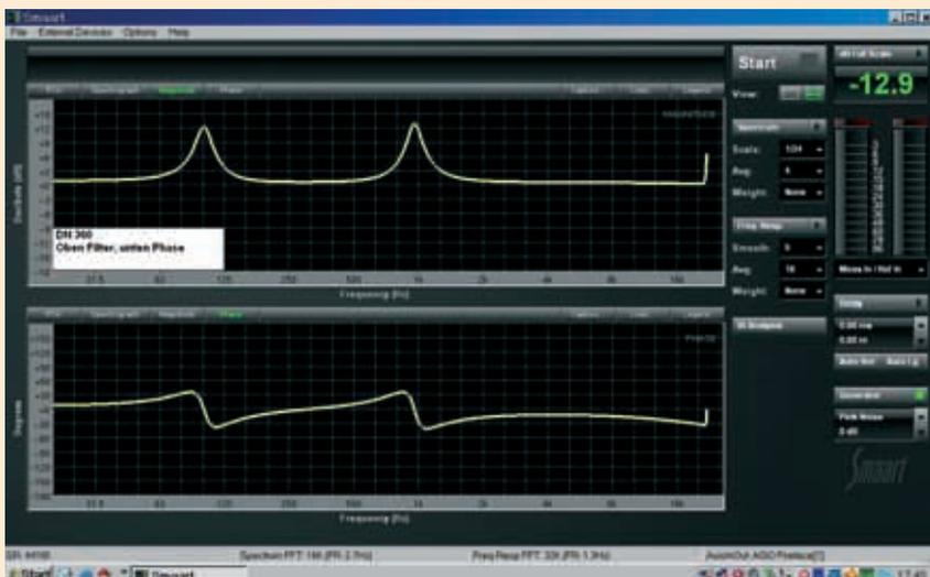
Bild 4: Filter 100 Hz und 1 kHz des Klark DN-360 voll angehoben
