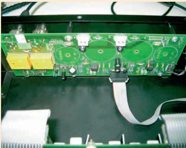
Bild 7: Die XLR-Anschlussplatine mit den Bypassrelais und den optionalen Trafoaufnahmen (runde Kreise)
