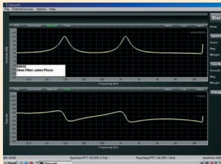
Bild 5: Filter 125 Hz und 1,25 kHz des Klark DN-332 voll angehoben
