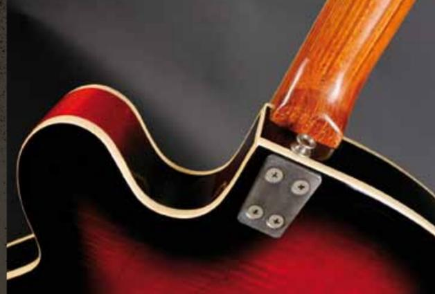
er heißt. Waren die ersten Versionen spatelförmig mit sternartigen oder „Split-Parallelogramm“-Perlmuttereinlagen verziert, mussten sie später einer Version im Paddel-Look mit Messingeinlagen als Schriftzug und Zierrosette weichen. Der massive verchromte Saitenhalter wurde durch ein Scharnier flexibel gelagert und mit vier Schrauben an der Zarge befestigt; formal an die Saitenhalter der Lang Archtops erinnernd, trug er zur eindeutigen Identifikation die Gravur „Star-Bass“.
