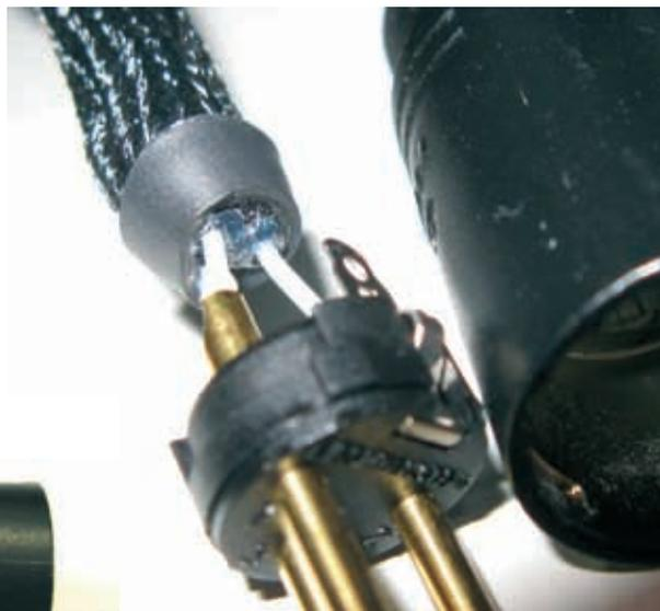
Sehr aufwändiges Präparieren der Kabelenden bei Vovox
