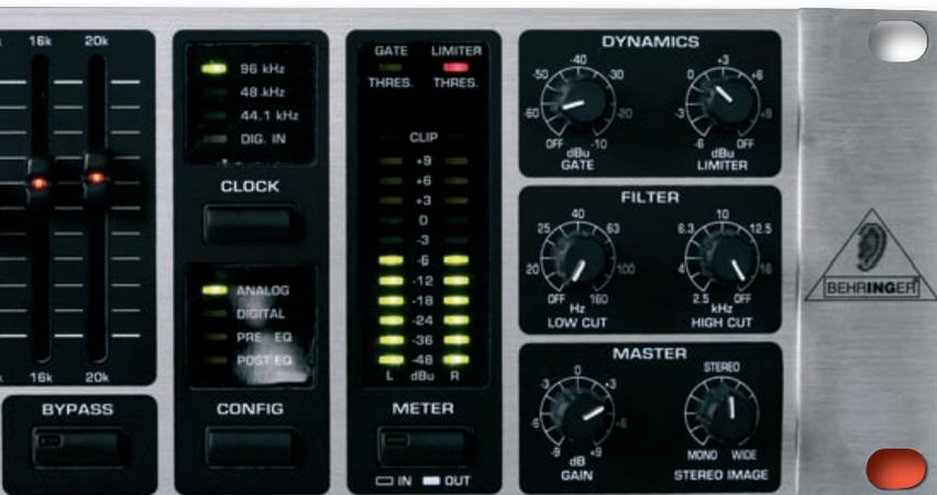
Die Bedienoberfläche des DEQ-1024 ist selbsterklärend, aber: Der Limiter-Threshold wird schon erreicht, weit bevor die Metersektion die eingestellten Werte anzeigt
