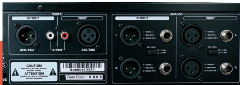
Das Anschlussfeld des Behringer DEQ-1024 lässt kaum Wünsche offen - an den digitalen Buchsen lassen sich auch weitere Digital-Prozessoren einschleifen
