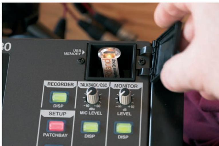
Unter einer Abdeckung findet sich der USB-Port für Memorysticks, der Wav-Mitschnitte und den Austausch von Konfigurationsdaten möglich macht – bei eingestecktem Stick, der sich im Lieferumfang befindet, lässt sich die Klappe allerdings nicht mehr schließen
