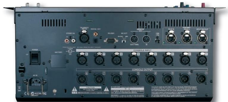
Anschlüsse und Schnittstellen auf der Rückseite des M-380
