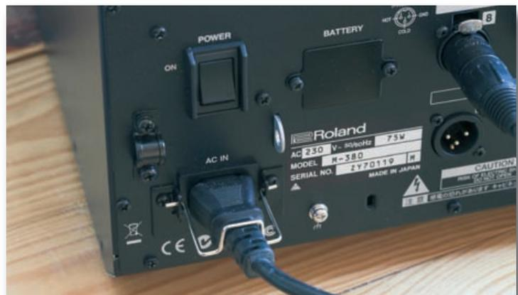
Vorbildlich: Befestigungsoptionen für den Netzanschluss sind bei Rackeinbau unverzichtbar
