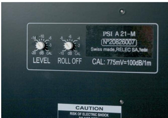
Nicht edel, aber zweckmäßig: Drehregler für Eingangsabsenkung und Raumanpassung auf der Rückseite der A21-M
