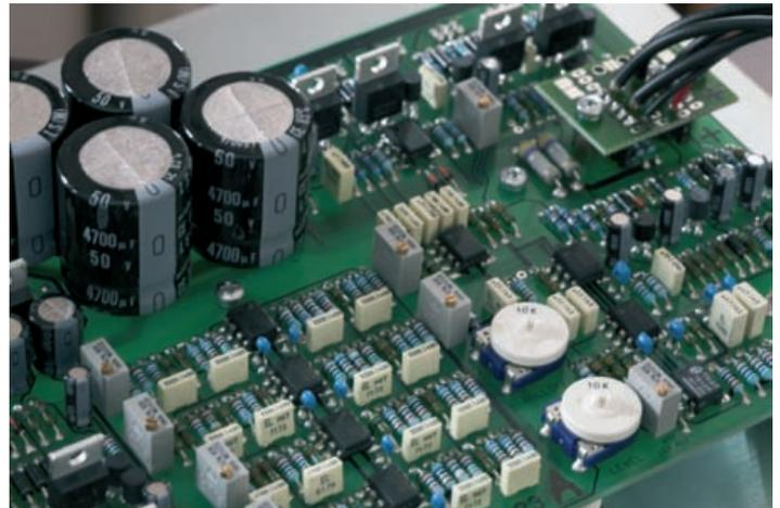
Ein Mehr an Analogelektronik kitzelt das Optimum aus den verwendeten Chassis heraus: Hier die Weiche der A-21 M
