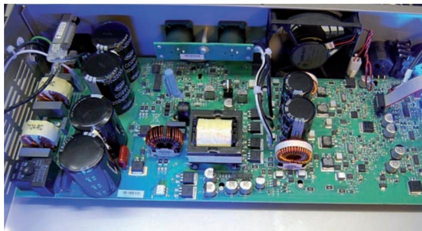
Bild 1: Alles auf einer Platine (die Luftführung über den Endtransistoren ist für das Bild entfernt worden)
