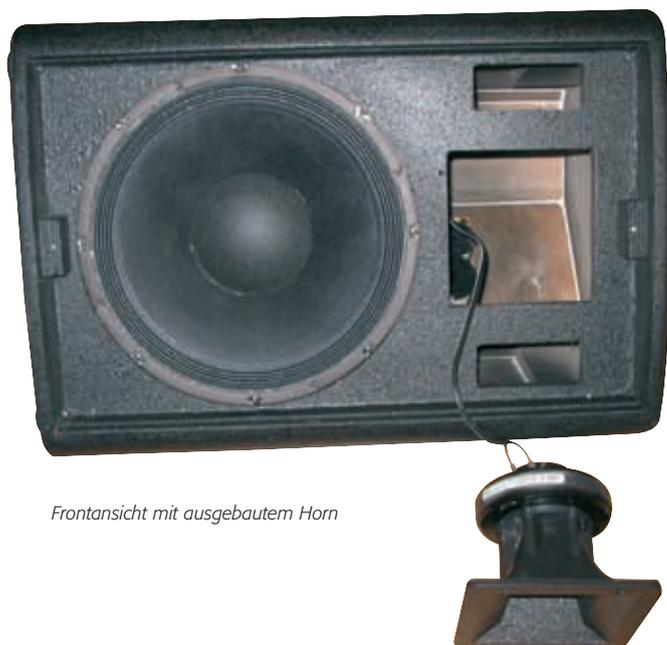
*Frontansicht mit ausgebautem Horn*
