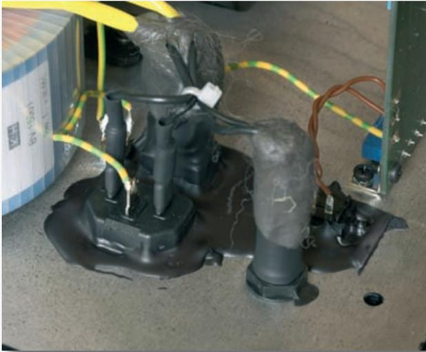
Das geschlossene Gehäuse erfordert besondere Dichtungs- und Dämpfungsmaßnahmen – hier klappert nichts
