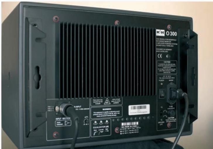
Der massive Kühlkörper macht Lüfter überflüssig; das im Bild sichtbare Montageblech ist als Aufnahme für optional erhältliche Hängevorrichtungen gedacht und für eine direkte Montage an Wänden nicht zu gebrauchen
