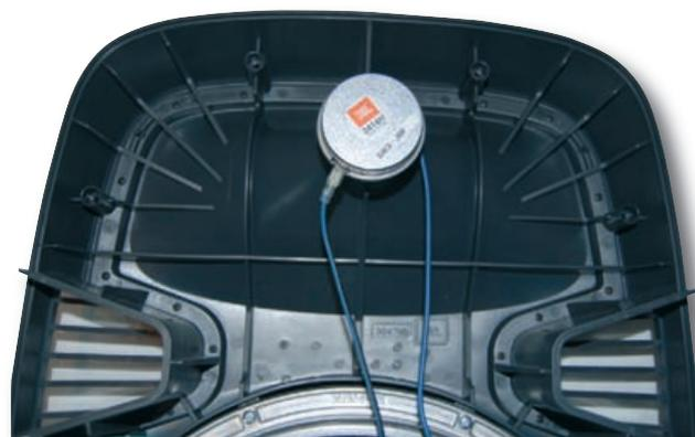
Abb. 4: Sicht von hinten auf das Hochtonhorn, wo dessen leicht asymmetrische Kontur mit „Neigung“ nach unten erkennbar ist
