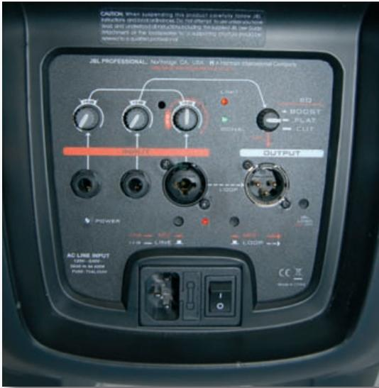
Abb. 2: Minimixer auf der Gehäuserückseite mit 2 x 6,3 mm Klinkeneingängen, XLR-Kombi-Eingang sowie XLR-Ausgang.
