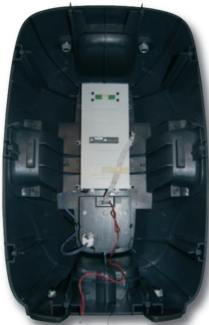
Abb. 5: Geöffnete Unterschale der Box (Dämpfungsmaterial wurde für das Foto entfernt)
