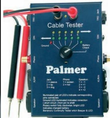
Bild 4: Palmer MCT-7 (ganz links), der jetzt mit dem MCT-8 einen Nachfolger mit erweiterten Möglichkeiten bekommen hat: Es kann mit Hilfe der mitgelieferten Testspitzen für die Banana Plugs jedes Kabel und jeder Stecker durchgang geprüft werden. Die Anzeige erfolgt durch LED und Buzzer. Der MCT-8 hat ein Batterieeinschubfach für problemloses Wechseln der Batterie. Buchsen: Speakon/XLR male/XLR female/Phono/DIN/TRS-Jack (6,3 mm Klinkenbuchse)/Banana Buchse plus zwei Testspitzen.
