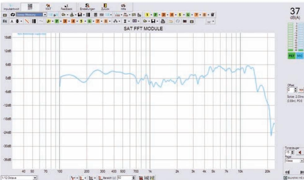
Abb. 7: Frequenzgangmessung mit „SATlive“ (64 k FFT, gefenstert ca. 6,15 ms, Glättung 1/12 Oktave, Rechteckfilterung)
