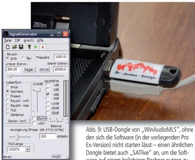
Abb. 9: USB-Dongle von „WinAudioMLS“, ohne den sich die Software (in der vorliegenden Pro Ex-Version) nicht starten lässt – einen ähnlichen Dongle bietet auch „SATlive“ an, um die Software auf einem beliebigen Rechner nutzen zu können
