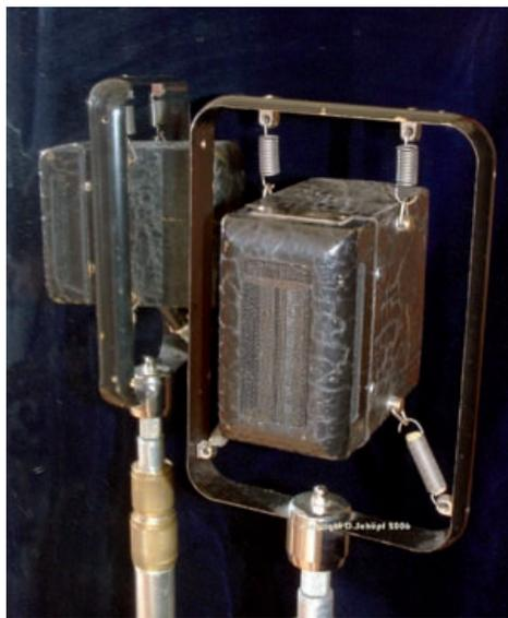
Abb. 10: das erste serienmäßige Bändchenmikrofon mit Permanentmagneten, um 1928: Siemens & Halske ELM 21 (Ela M-2/1)
