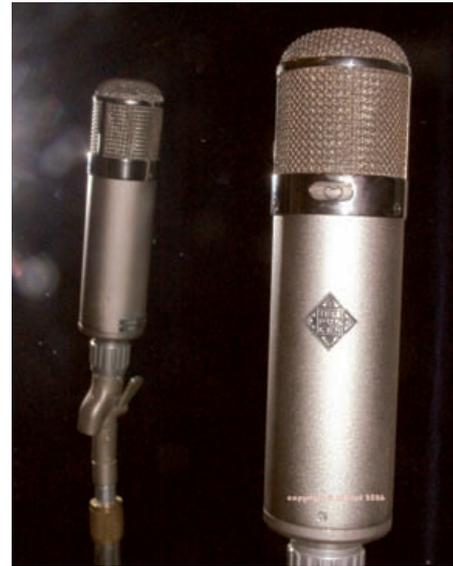
Abb. 13: Das U-47-Mikrofon – hier mit Telefunkenlogo – verdankt seine spezielle Frequenzkurve auch dem dreilagigen Korbgritter
