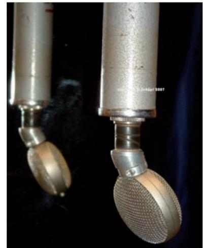
Abb. 5: Die versierten DEFA-Techniker bauten zur Filmtonaufnahme eine Spezial M-7 für ein Gefell CMV 563-Mikrofon
