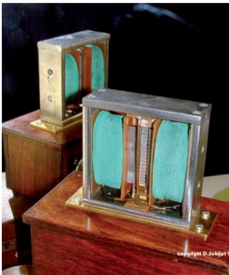
Abb. 9: Nachbau des ersten, 1923/24 patentierten elektrodynamischen Bändchenmikrofons von Siemens & Halske
