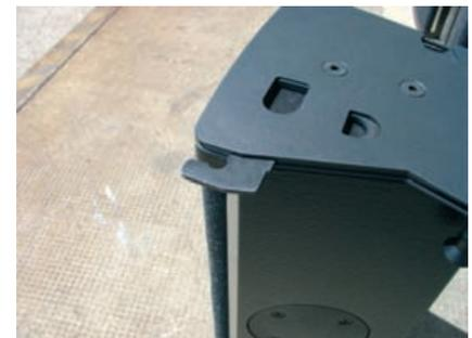
Der erste Schritt beim Aufbau ist das Ausfahren der Hacken, mit denen die Boxen aneinander gehängt werden – lose Teile? Fehlanzeige!
