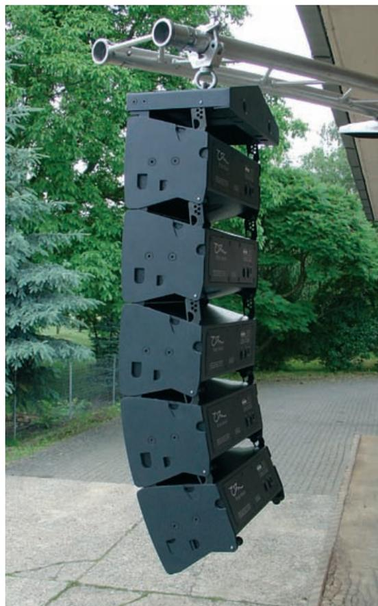
Das fertige Array, hier mit fünf Boxen – das ganze System kann aus maximal acht Boxen bestehen und ist für eine Beschallung bis zu 2.000 Personen ausgelegt
