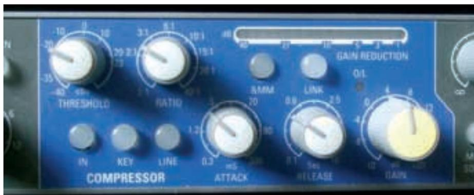
Typische Bedienoberfläche eines Kompressors
