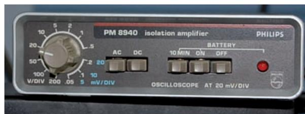
Bild 2: Der Isolationsverstärker Philips PM-8940 sorgt für problemlosen Anschluss der Lautsprecherausgänge an unser Messsystem
