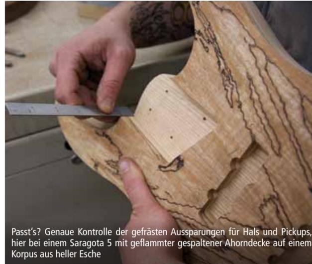
Passt's? Genaue Kontrolle der gefrästen Aussparungen für Hals und Pickups, hier bei einem Saragota 5 mit geflammter gespaltenen Ahorndecke auf einem Korpus aus heller Esche
