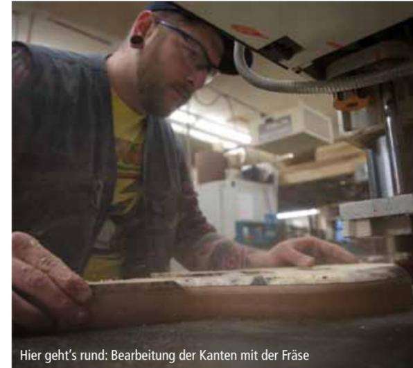
Hier geht's rund: Bearbeitung der Kanten mit der Fräse
