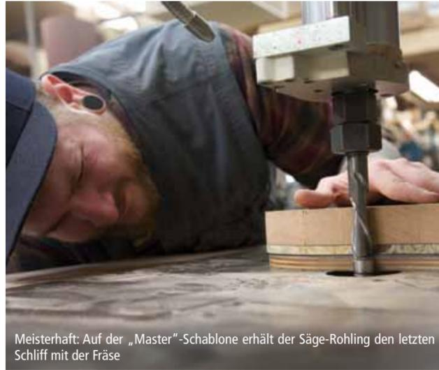
Meisterhaft: Auf der „Master“-Schablone erhält der Säge-Rohling den letzten Schliff mit der Fräse
