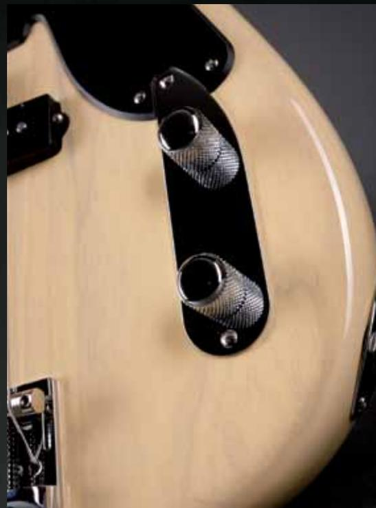
auf einer separaten kleinen Kontrollplatte montiert. Praktisch, dass man bei eventuellen Problemen der Einfachst-Elektrik nach dem Lösen von ganzen zwei Schrauben unter die Haube schauen kann. Auf Speckdeckel und Daumen-/Fingerstützte wurde komplett verzichtet.
