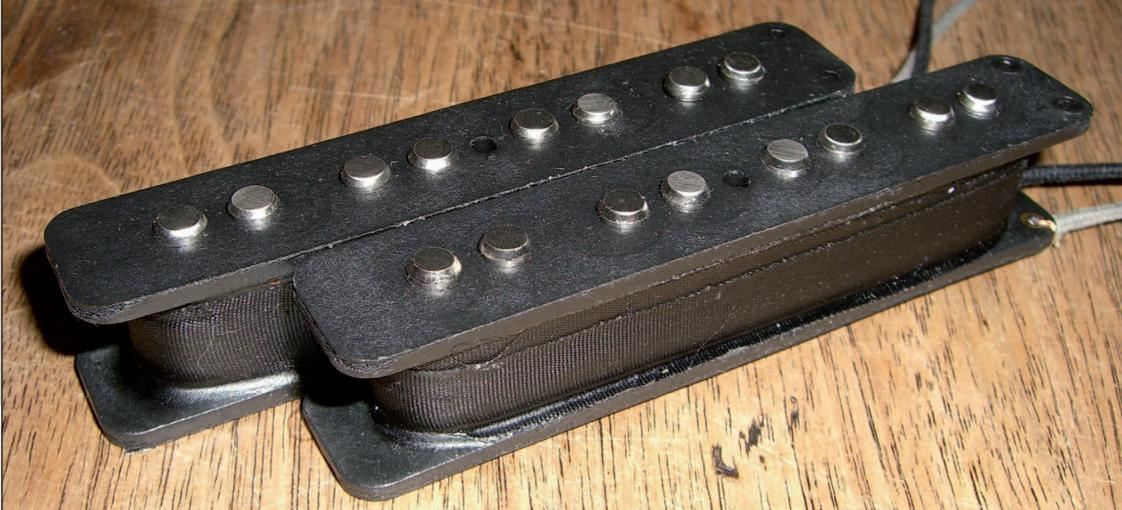
dünnere) Drahtstärke sein, denn bei üblicher 42 AWG Bewicklung wäre die JB-Spule bei 10 kOhm schon reichlich voll. Die Oberkanten der einzelnen Stabmagnete wurden auch bei den J-Single Coils von Hand angeschrägt, hier allerdings nur ganz dezent. Auch stehen die Magnete nicht oder zumindest kaum merklich aus den Kappen heraus, sind also „flush“ pole pieces. Selbstverständlich auch hier stoffummanteltes Anschlusskabel, wie früher.
