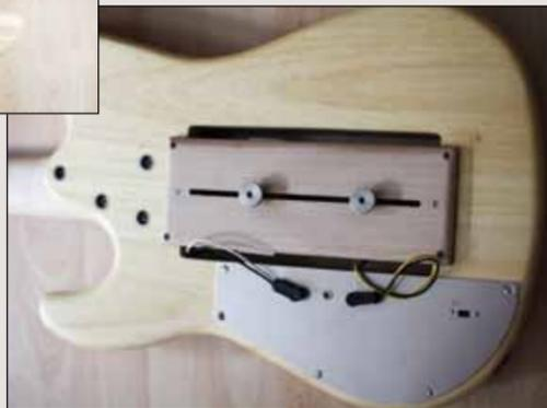
▶ Rückseite: Die Holzplatte ermöglicht den schnellen Austausch der Tonabnehmer, die mit kleinen Klinkensteckern am Bass verkabelt werden
