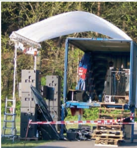
Solche Aufbauten halten keinen größeren Windkräften stand (Foto: www.chrickel.eu)
