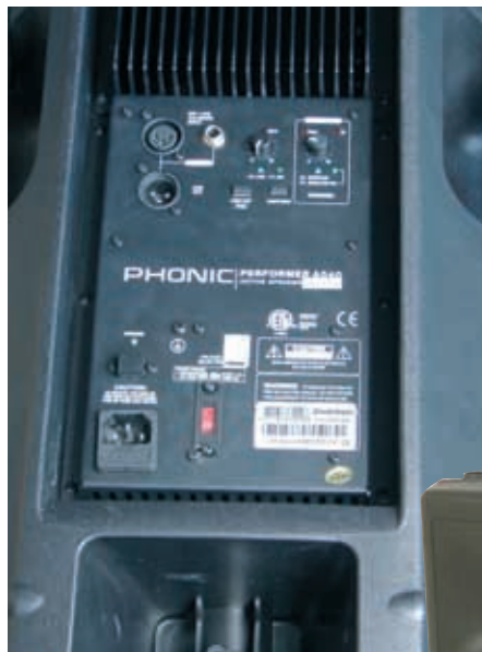
Neben den üblichen Bedienelementen finden sich auch ein Pegelsteller für die Funk-Module auf der Rückseite der PFA-540
