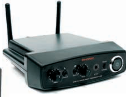
Der WM-70-Sender, mit dem sich Audio-Signale zu den »Performer« senden lassen
