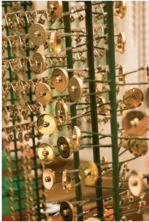
Sämtliche Kleinteile (wie z.B. hier im Bild Deckel von Drehzylindermaschinen) müssen für eine Vergoldung oder Versilberung sorgfältig und frei einzeln aufgehängt werden.
