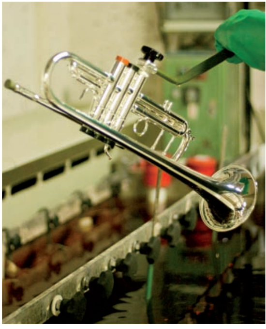
Eine neu versilberte Bb-Trompete wird aus dem elektrolytischen Bad herausgenommen. Sämtliche Öffnungen des Instrumentes sind während des Galvanisierungsvorgangs dicht verschlossen.
