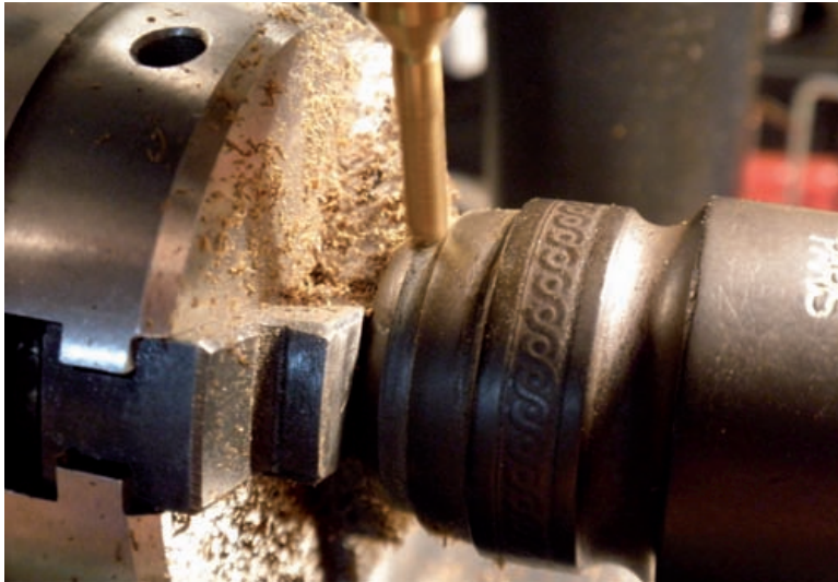
Für den Verstärkungsring wird eine Nut eingefräst
