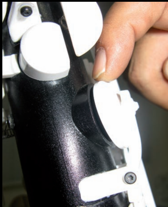
Das Blitzlicht macht die Klebefuge zwischen den beiden Teilen des Hauptrohrs (unten, horizontal), aber auch die (senkrechte) Linie der Werkzeugteilung des oberen Rohrteils sichtbar.
