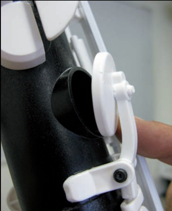
Seitliche C-Klappe, geöffnet. Die kugelgelenkige Aufhängung des Polsters erlaubt ein selbsttätiges Ausrichten. Am Tonloch wird die relativ große Wandstärke des Korpus erkennbar.
