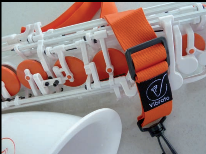
Die Mechanik der linken Hand, Serienmodell A1S. Die gummiartigen Polster werden in die Mechanik eingeklippt und richten sich beim Spielen selbst aus. Zu erkennen ist außerdem der mehrteilige Aufbau der einzelnen Tasten, bei dem die Achse durch einen Aluminium-Sechskant gebildet wird.
