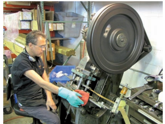
Aus Messingstreifen werden kleine Hülsen gestanzt
