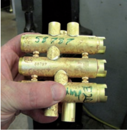
Die Serien-Nr. wird auf dem Ventilblock vermerkt
