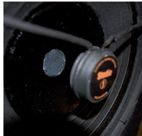
Hochtöner einmal anders: Der integrierte Hochtöner strahlt rückwärtig auf die speziell angehaute Membran, wodurch das Signal angenehm diffusiert wird.
