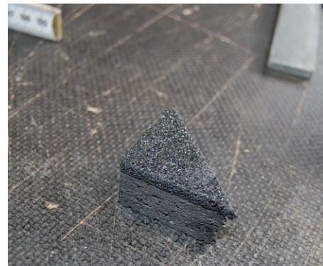
Spezielle Klötzchen zur Befestigung des Frontgitters verhindern Vibrationen
