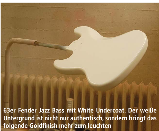
Zwischenschliff eines 63er Jazz Basses mit 800er Schleifleinen
