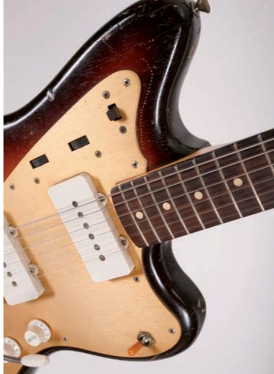
fügt das Preset-Rhythm-Circuit über Mini-Potentiometer von Clarostat (1 Meg lin. und 50k lin.), bedienbar mittels aus dem Pickguard ragender „thumb wheels“ aus Metall, sowie ein axiales .02 mfd „waxed paper cap“, ebenfalls von Cornell Dubilier. Die Verkabelung erfolgte mit 22 awg Baumwoll-isolierter Litze.
