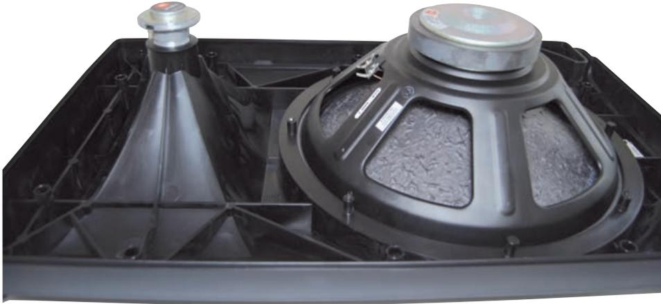
Abb. 3: Hochton-Kompressionstreiber JBL 2414H-1 und Tieftonchassis JBL 615H, jeweils aus JBL-eigener Fertigung, welche auf die abnehmbare Frontseite montiert sind (hier in der Rückansicht)
