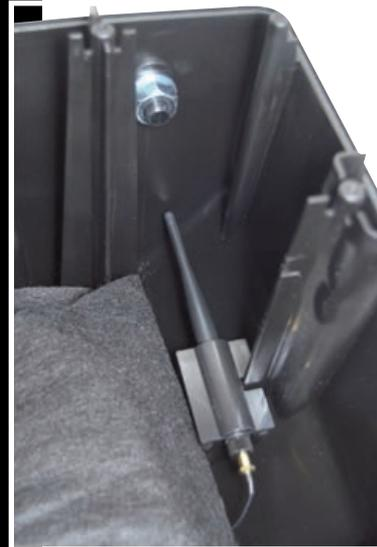
Abb. 2: Blick in das geöffnete Gehäuse – Bluetooth-Antenne in der rechten oberen Gehäusesseite sowie gekonterte M10-Gewindebuche zur Aufnahme einer Ringöse
