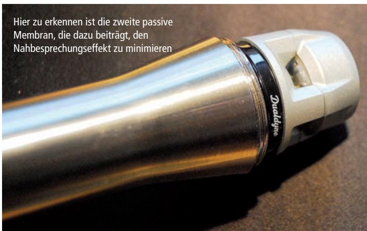
Hier zu erkennen ist die zweite passive Membran, die dazu beiträgt, den Nahbesprechungseffekt zu minimieren
