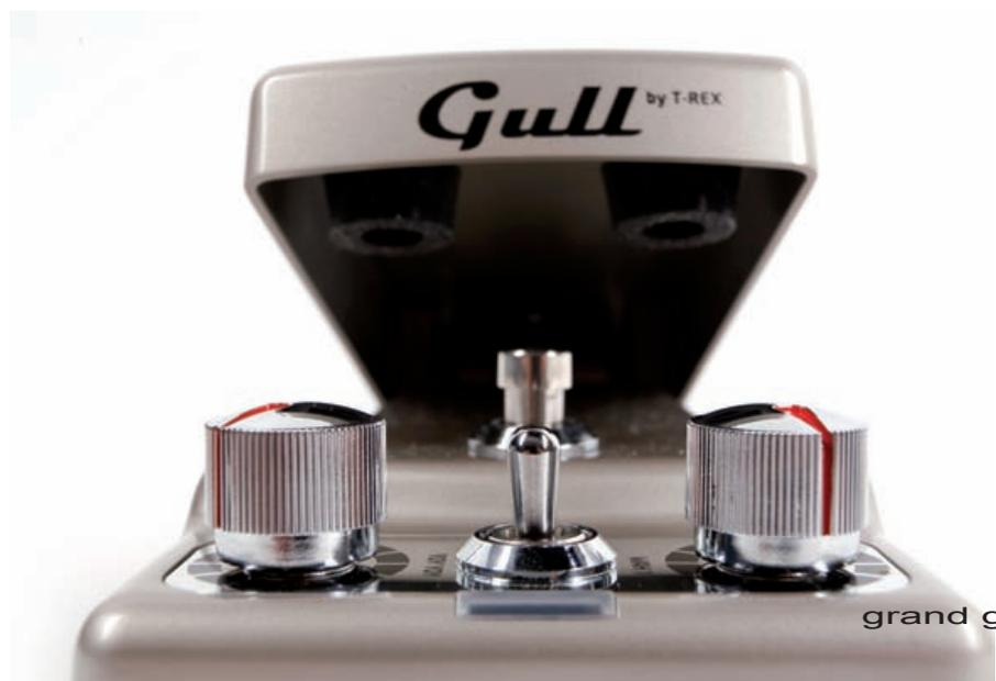
aufgedrehtem Slope eine ordentliche Schippe Kompression ins Spiel kommt. Dabei passiert aus physikalischer Sicht folgendes: Der Regler ändert die Kennlinie des Filters von einem relativ engen Frequenzband hin zu einer sehr breitbandigen Filterung, bei der viele tiefe und hohe Frequenzen „mitgenommen“ werden.
