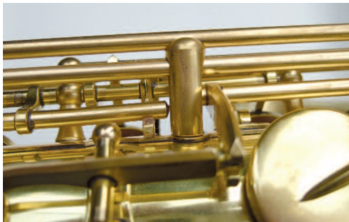
Gut: schraubenlose Führung für die langen Achsen
