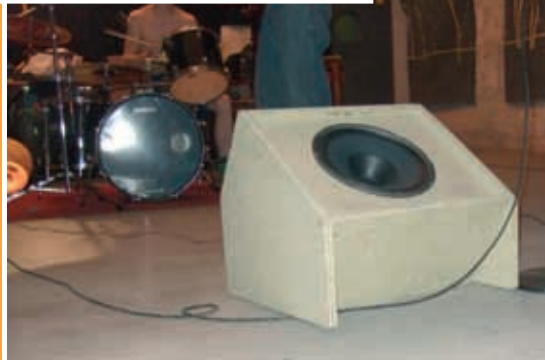
Rechtwinklig mit „extended“ Seitenwänden, einfacher kann man ein Gehäuse nicht bauen
