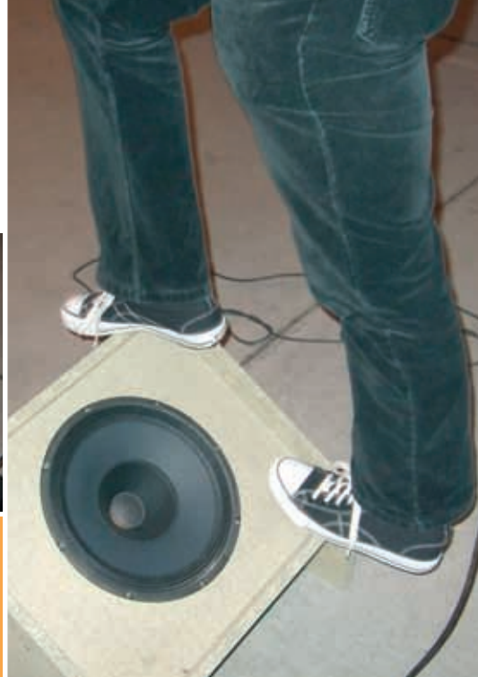
Belastungstest des Gehäuses
