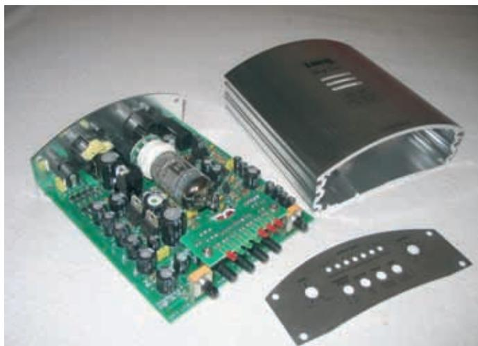
*Innereien: Die Schaltung kombiniert Transistor- und Röhrentechnik miteinander - als erstes verstärkendes (und damit maßgebliches) Glied in der Signalkette arbeitet ein mit mehreren Transistoren diskret aufgebauter, ...*
