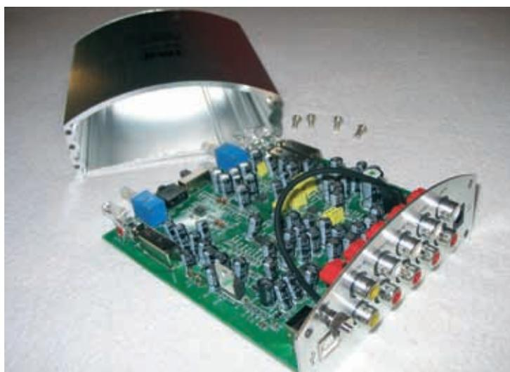
*Zusätzlich zur eigentlichen Bestimmung, nämlich dem Digitalisieren analoger Audiosignale, lässt sich das Gerät prima auch als reiner analoger Phono-Preamp und ebensolcher Kopfhörerverstärker verwenden*
