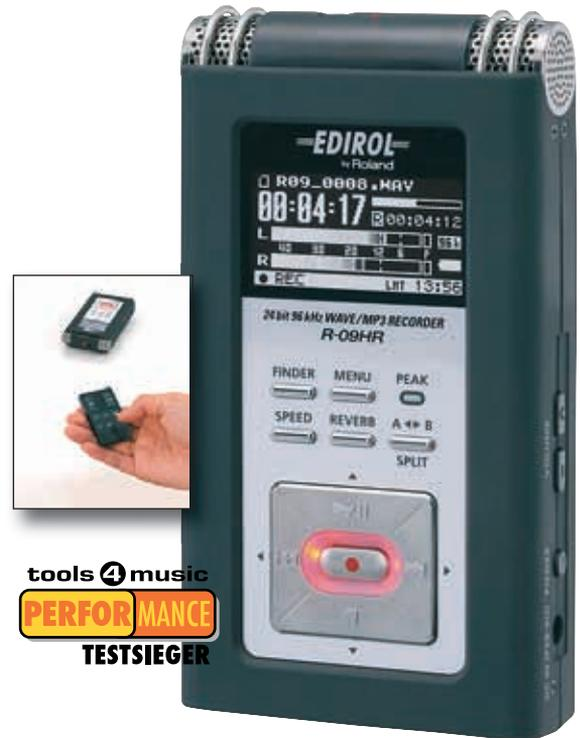
Der Edirol R-09 HR bietet eine Infrarot-Fernbedienung im Lieferumfang und arbeitet mit herkömmlichen Akkus, die sich einfach wechseln lassen
