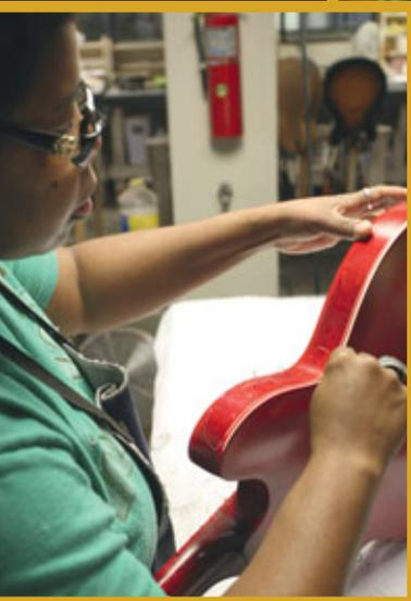
Das überlackierte Binding wird von Hand mit einer Ziehklinge abgezogen, eine Aufgabe, die nur Frauen bei Gibson ausführen
