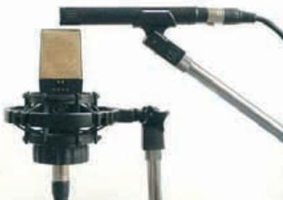
Bild 10: MS-Anordnung mit einem AKG C-414 (Großmembran) als Acht und einer Kleinmembran mit Niere-Charakteristik
