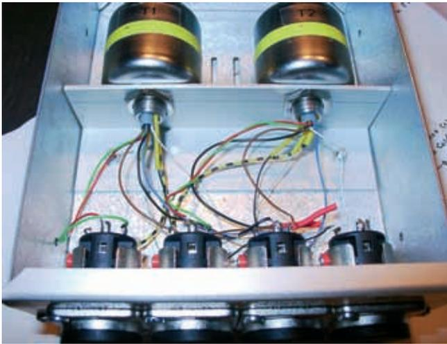
Bild 7: Einer meiner DIY MS/LR Konverter mit Haufe-Übertragern
