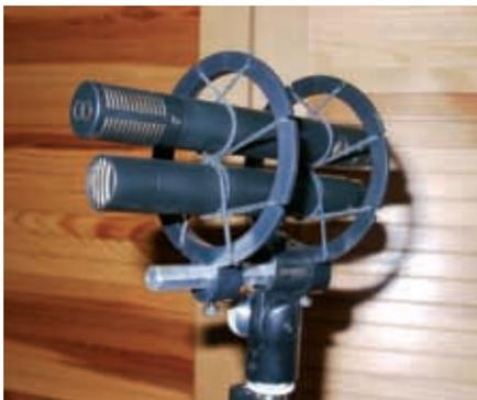
Bild 9: MS Anordnung mit MBHO KA-300 und KA-800 Kapseln
