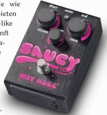
Dabei wurde bei Way Huge auf einen über den gesamten Drive-Regelweg gleichbleibenden Lautstärkepegel und einfachste, intuitive Bedienung Wert gelegt. Clean- und Overdrive-Schaltkreise sind komplett diskret aufgebaut, also ohne den Einsatz integrierter Schaltungen (ICs). Die Saucy Box ist made in USA, mit True Bypass und ab Januar 2015 über den Fachhandel lieferbar.
