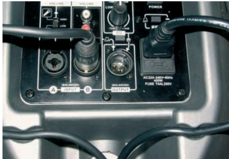
*Kleines aber feines Detail, so wird bei der Titan der Kabelzug entlastet.*
