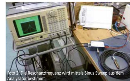
Foto 2: Die Resonanzfrequenz wird mittels Sinus Sweep aus dem Analysator bestimmt
