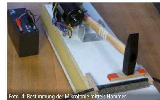
Foto 4: Bestimmung der Mikrofonie mittels Hammer
