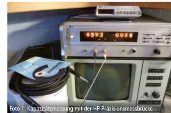
Foto 1: Kapazitätsmessung mit der HP Präzisionsmessbrücke
