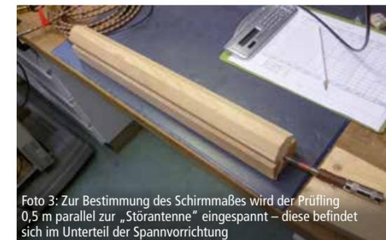
Foto 3: Zur Bestimmung des Schirmmaßes wird der Prüfling 0,5 m parallel zur „Störantenne“ eingespannt – diese befindet sich im Unterteil der Spannvorrichtung
