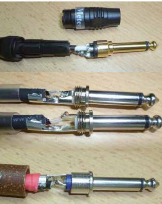
Foto 7: Verschiedene Konfektionsstile für die Klinkestecker: **Oben:** Sommer Cable LXGV-0600-SW – vorbildlich gelötet, aber ohne Spiel für die Zugentlastung **Mitte:** Thomann „The Sssnake IPP-1060“ – weder Zugentlastung noch Lötstellen sind akkurat ausgeführt **Unten:** Santo Angelo „Killswitch Acoustic 20“ – die Lötstellen sind in Ordnung, aber sowohl der Schrumpfschlauch als auch die Krallen der Zugentlastung knapp bemessen
