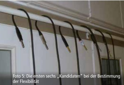
Foto 5: Die ersten sechs „Kandidaten“ bei der Bestimmung der Flexibilität
