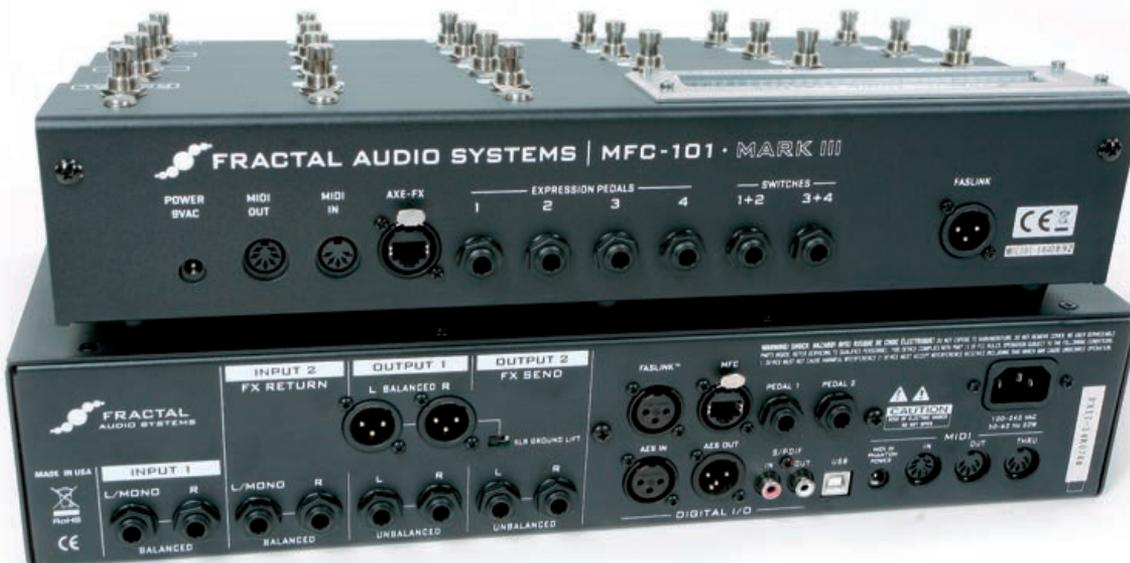
Rückansicht mal zwei – oben die Anschlüsse des Foot-Controllers, darunter das „Axe-FX“
