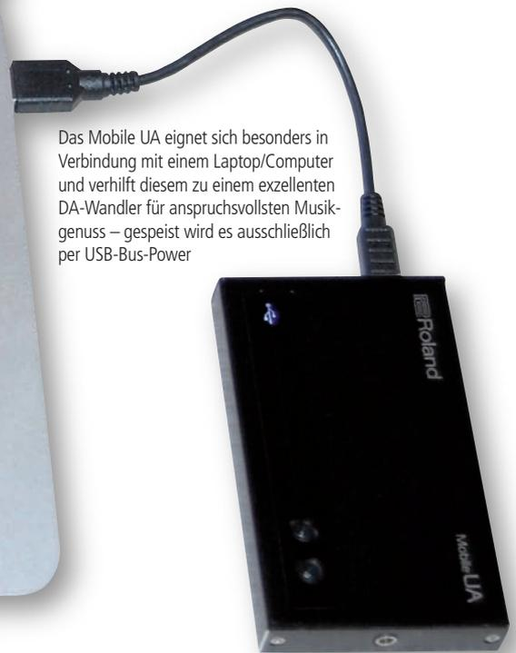
Das Mobile UA eignet sich besonders in Verbindung mit einem Laptop/Computer und verhilft diesem zu einem exzellenten DA-Wandler für anspruchsvollsten Musikgenuss – gespeist wird es ausschließlich per USB-Bus-Power
