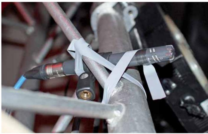
Abb. 13: An den seitlichen Bühnentraversen hat Stricker jeweils ein AKG C-391B Mikrophon befestigt als Ambience-Eindruck für den Audio-Mitschnitt
