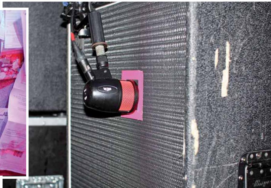
Abb.12: Bass-Amp Mikrofonierung: Heil PR-48
