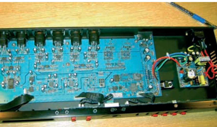
Bild 5: Innenansicht des the tracks DS-2/4 PA-Controllers
