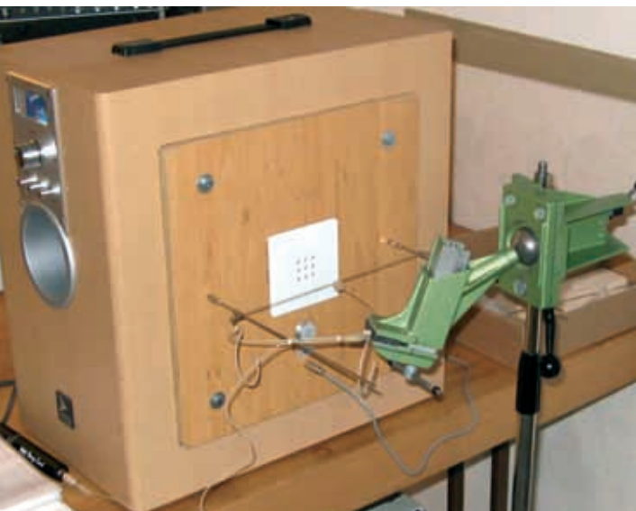
Ploppempfindlichkeit messen nach DIN mit der eigens gebauten „Ploppmaschine“
