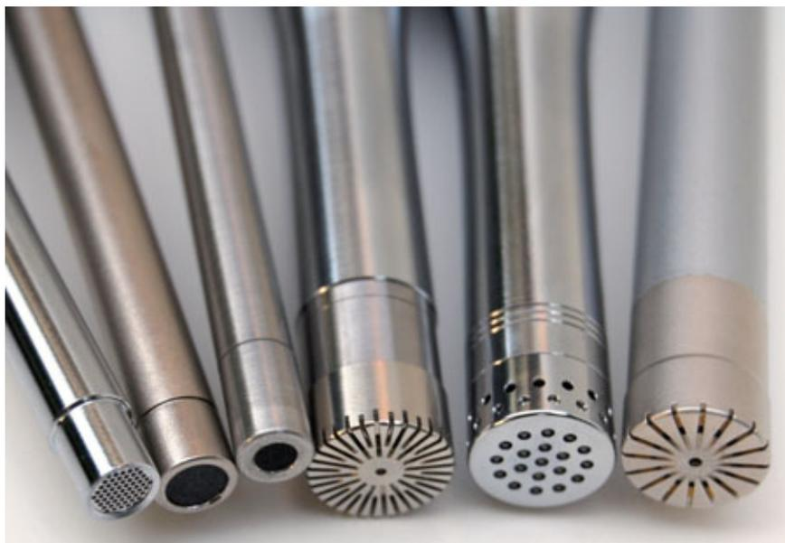
**Abb. 1:** Testfeld mit ¼-Zoll- (links) bzw. ½-Zoll-Kapseln (rechts): NTi Audio M4260, Audix TM-1, iSEMcon EMX-7510, NTi Audio M2230, Dr-Jordan-Design ATD-4S und NTi Audio M2211 (von links nach rechts)
