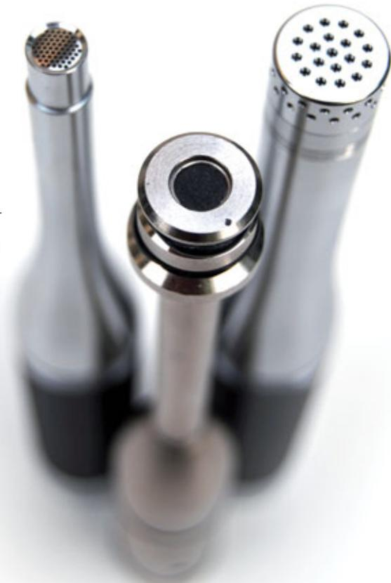
**Abb. 2:** Während viele Mikrofone über standardisierte Durchmesser zum Einstecken in genormte Schallpegelkalibratoren verfügen (das NTi Audio M4260 mit ¼-Zoll-Kapsel ist entsprechend verjüngt, links oben), wird beim Audix TM-1 ein Adapter benötigt, der den Durchmesser auf ½ Zoll vergrößert (mittig)
