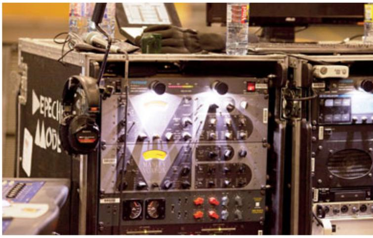
Abb. 6: Signalbearbeitung auf gehobenem Studio-Niveau: Die beiden Manley „Voxbox“-Channelstrips dienen dem Gesang von Dave Gahan und Martin Gore, darunter ein Chandler TG-1 und ein GML 8900 Kompressor
