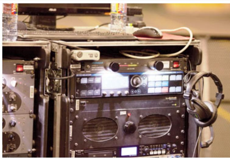
Abb. 7: Unter dem TC Helicon „VoiceLive“-Prozessor befinden sich zwei Talkback-Monitore im Rack; ein „Gimmick“, wie King bekennt, aber eine Alternative, statt Boxen auf dem Pult zu platzieren: „Ein Gerät, das man nicht manuell verstauen muss, ist eine Sache weniger, die kaputtgehen kann.“
