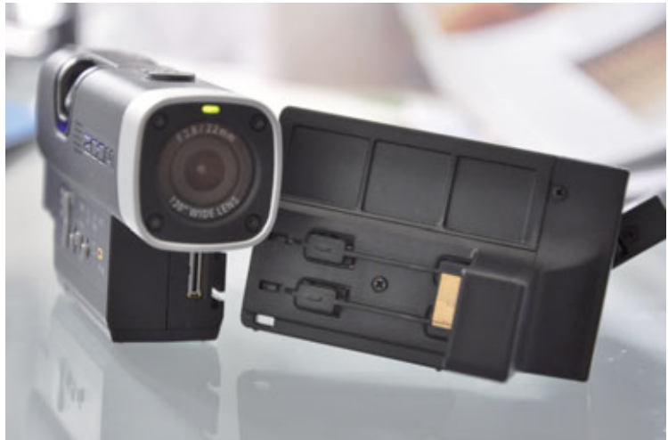
Um die Betriebsdauer zu verlängern und den Q-4 für den Live-Einsatz so kompakt wie möglich zu halten, lässt sich das LCD-Modul einfach abnehmen
