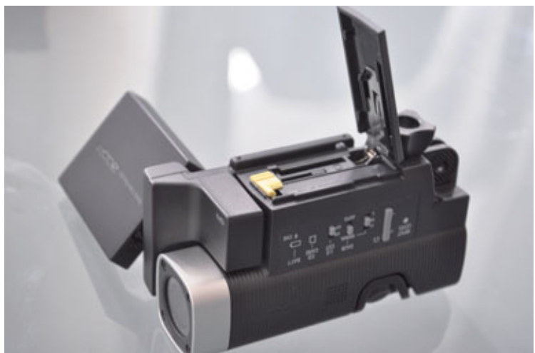
Auf der Unterseite befinden sich das Akku-Fach, der SC-Karten-Slot und das 4-Zoll-Gewinde, um den Fellwindschutz zu fixieren oder den Q-4 direkt auf einem Fotostativ zu montieren
